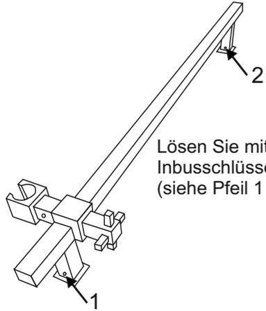
Lösen Sie mit einem passenden Inbusschlüssel die beiden Schrauben (siehe Pfeil 1 und 2).
