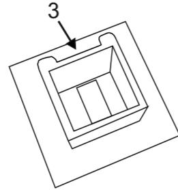
Schrauben Sie die abgelösten Befestigungen an die Innenseite der Dusche. Beachten Sie bitte, dass beide Einkerbungen (siehe Pfeil 3) nach oben oder unten zeigen und der richtige Abstand eingehalten wird.
